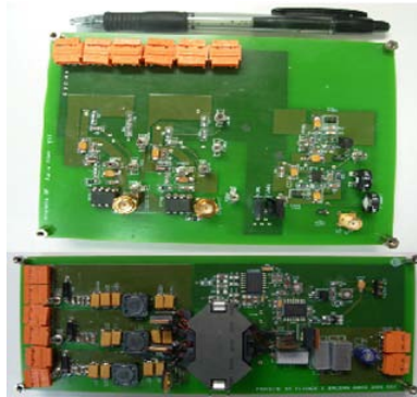
Figura 25 Fotografía del convertidor multinivel con celdas de dos estados. En la parte superior pueden observarse el módulo con las etapas dos y tres. El módulo de la parte inferior es el flyback multisalida de la primera etapa
